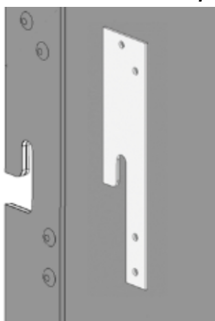
Figure 10 – Renfort d'encoche en centre de la cassette avec une tôle d'angle en aluminium EN AW-5754 t = 2\text{ mm} ou t = 3\text{ mm} (cf. du Tableau 4 au Tableau 14 pour plus de précisions)
