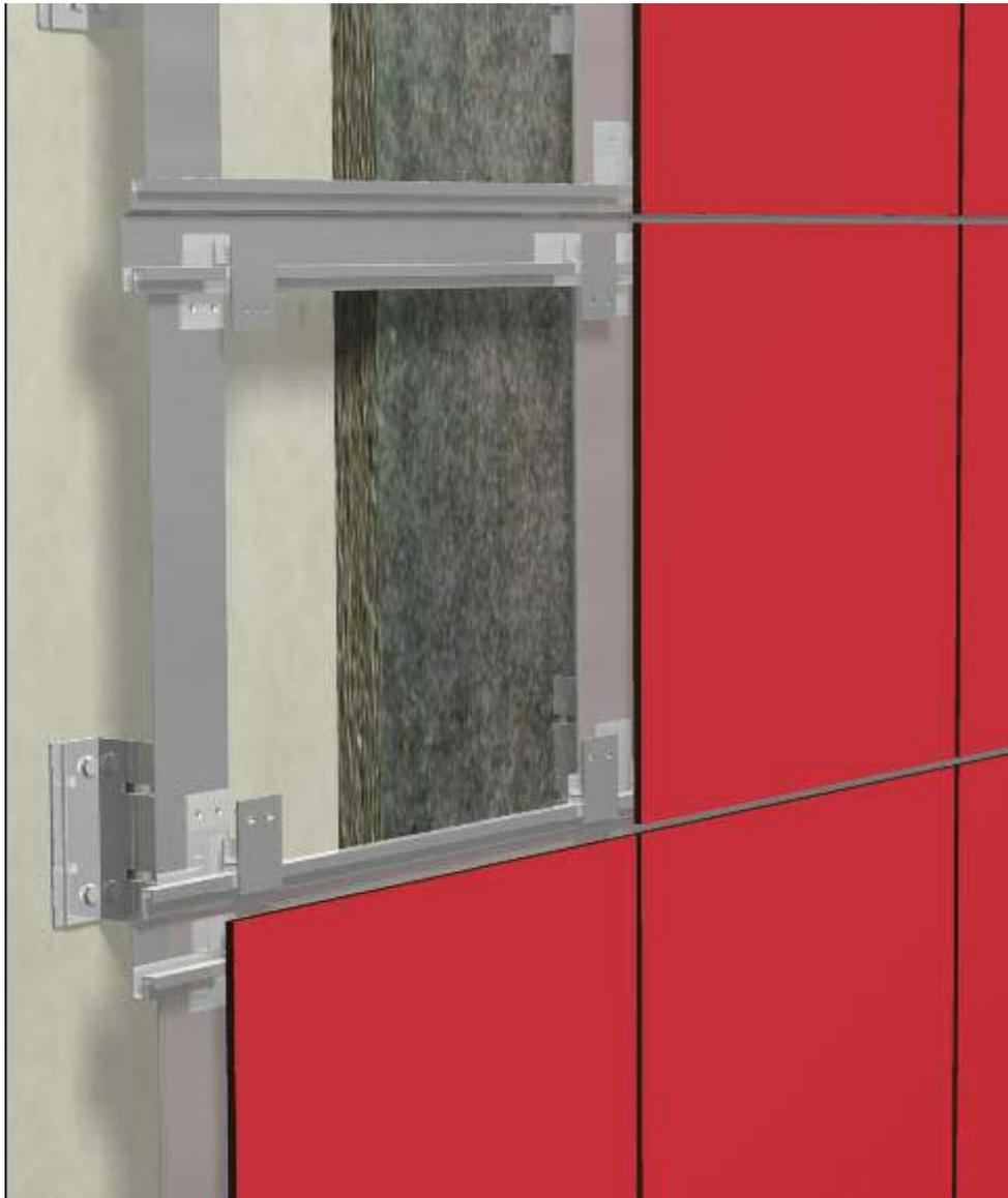
**Figure 2 – Détail pose directe sur le support**
