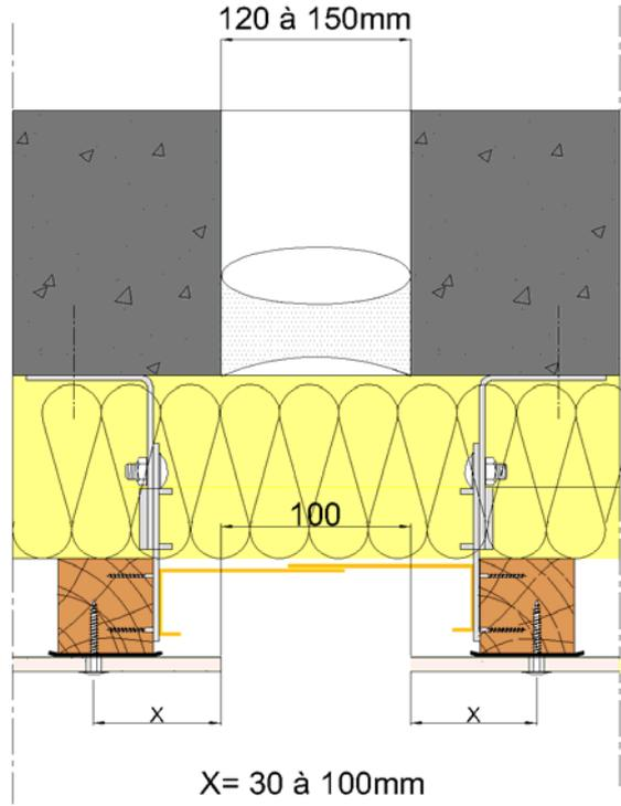
**Figure 40 – Joint de dilatation de 120 à 150 mm**
