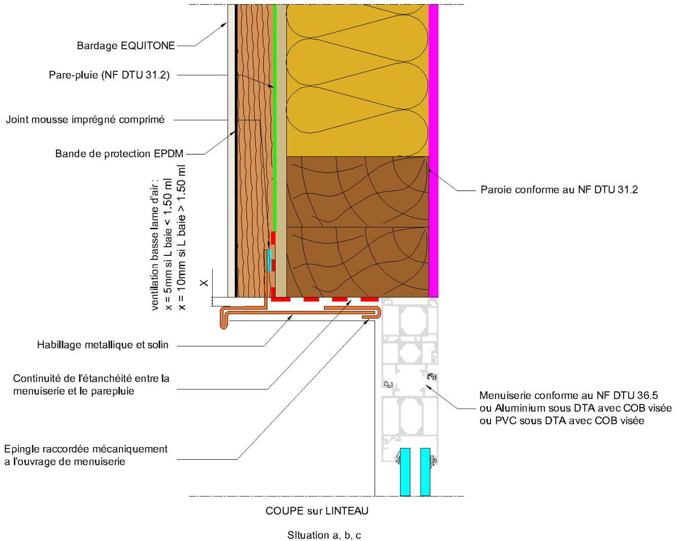
**Figure 30 – Pose sur COB – Coupe sur linteau de baie**
