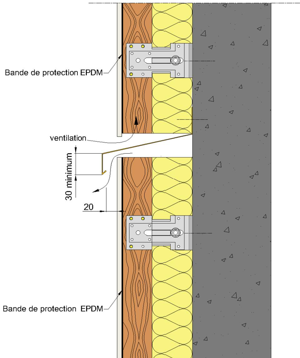
**Figure 14 - Fractionnement de la lame d'air**
