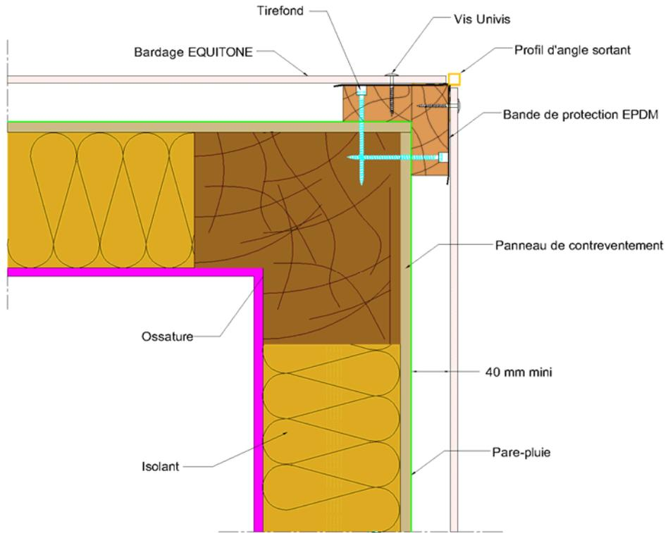
**Figure 26 – Traitement de l'angle sortant – Pose sur COB**
