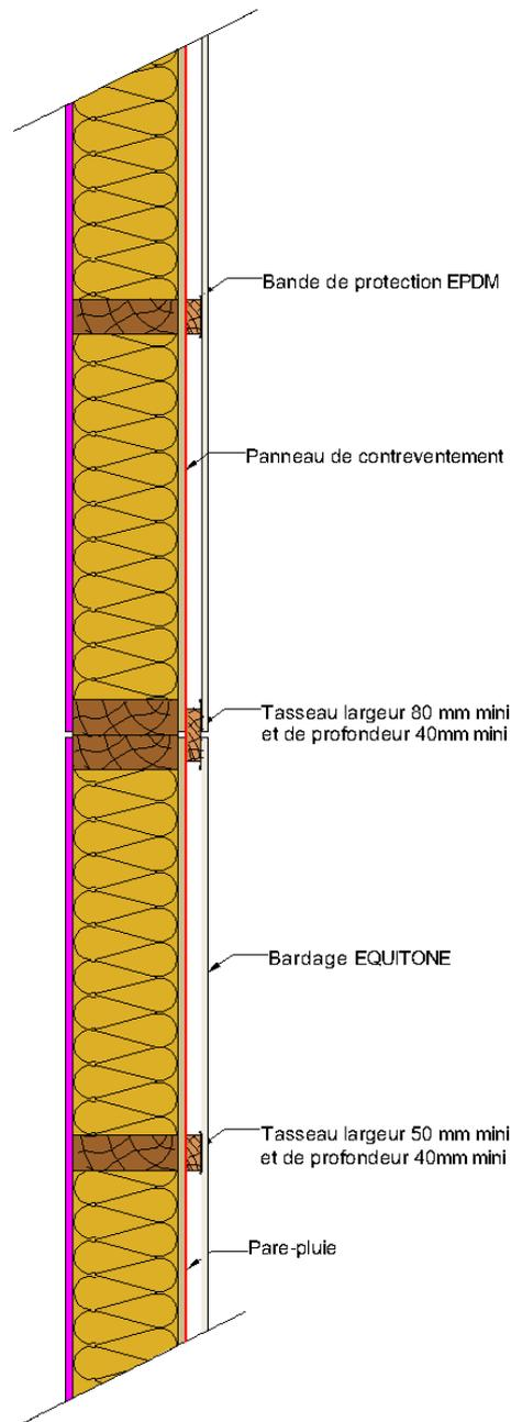
**Figure 18 - Pose sur COB - Coupe horizontale**
