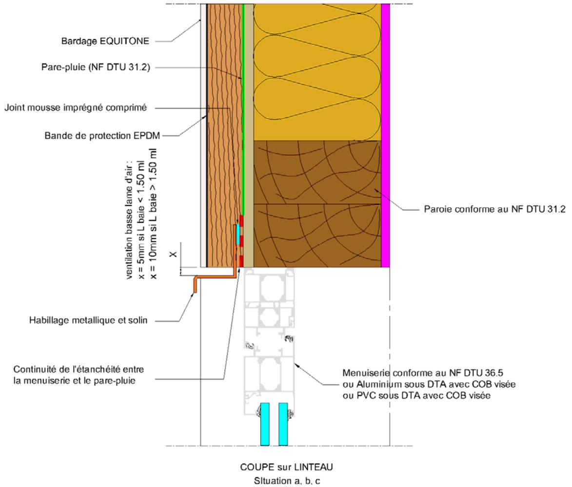
**Figure 34 – Pose sur COB – Coupe sur linteau de baie**
