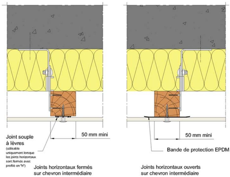
**Figure 7 - Fixation sur chevron intermédiaire**
