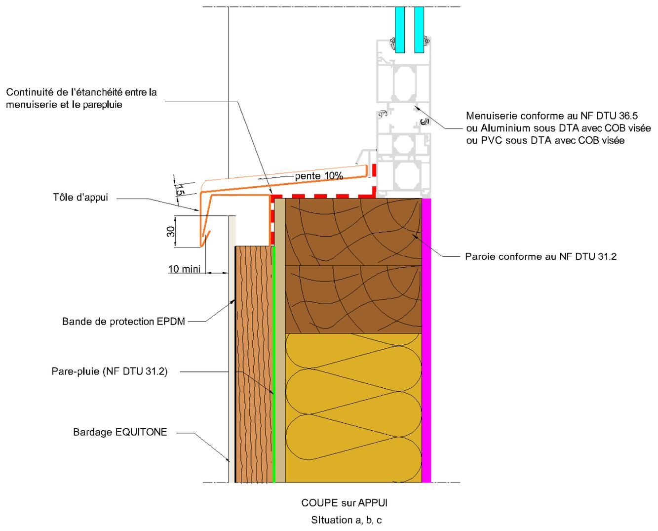
**Figure 31 – Pose sur COB – Coupe sur appui de baie**
