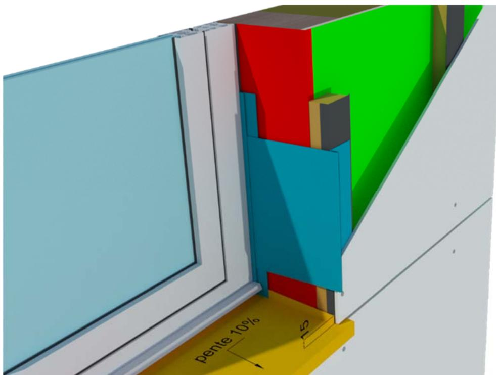
**Figure 33 – Pose sur COB – Perspective**
