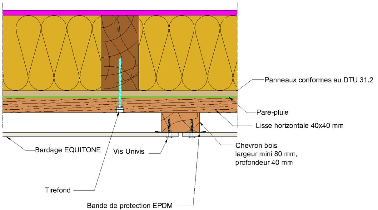
**Figure 25 – Principe de fixation sur chevron principal en ossature double croisée – Pose sur COB**
