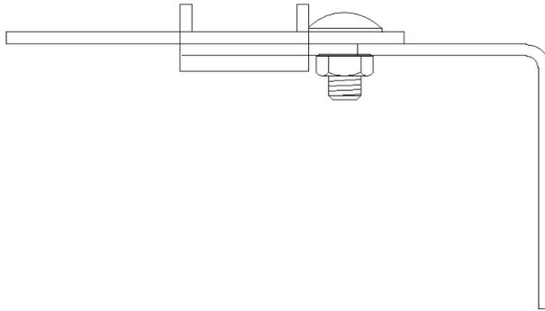
**Figure 2 – Equerre réglable EQUERELO, avec coulisse**
