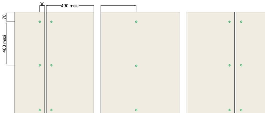
**Figure 41 – Principe de la pose en sous-face**
