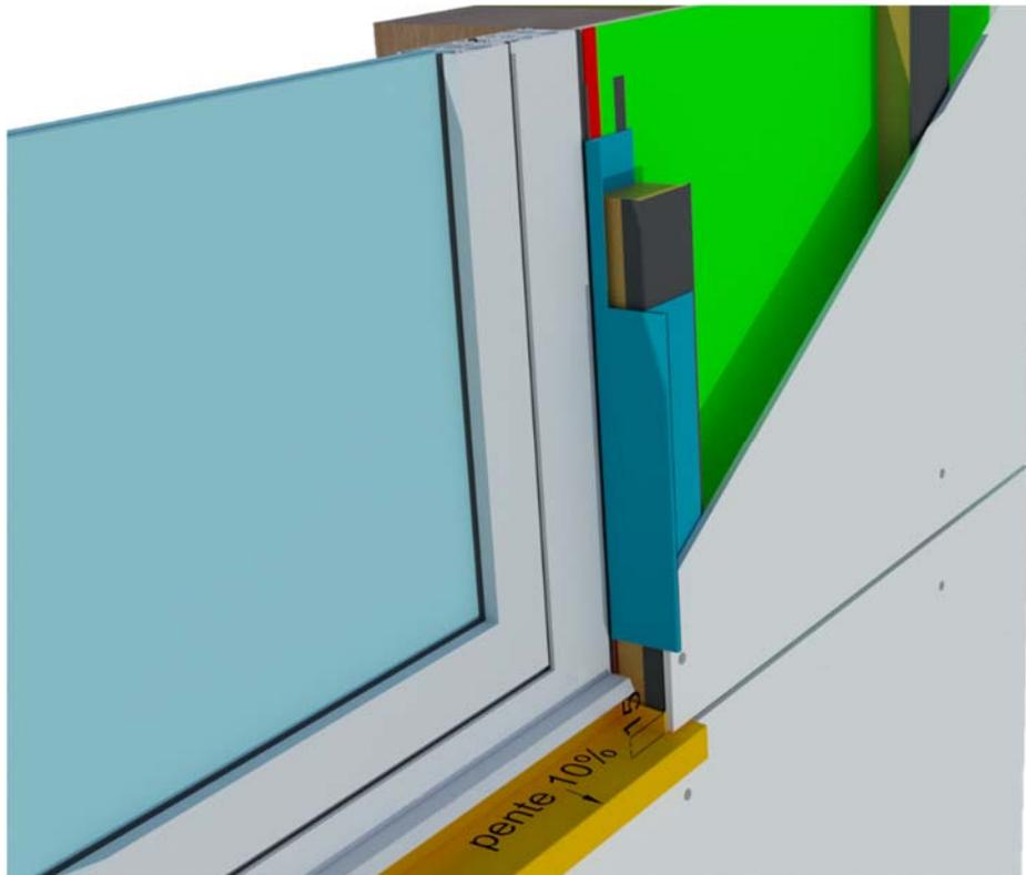
**Figure 37 – Pose sur COB – Perspective**
