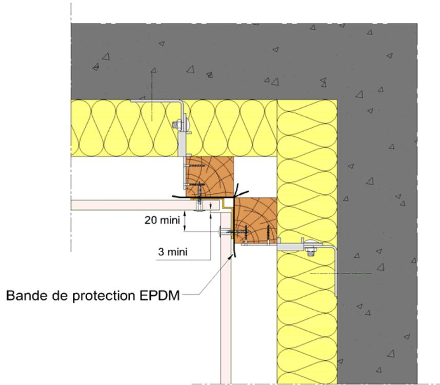
**Figure 12 - Angle rentrant (cas des joints horizontaux fermés)**
