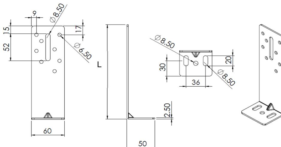
Résistance **ADMISSIBLE** sous charge des pattes-équerres SFS Type B conformément au cahier du CSTB 3316-V3 :
