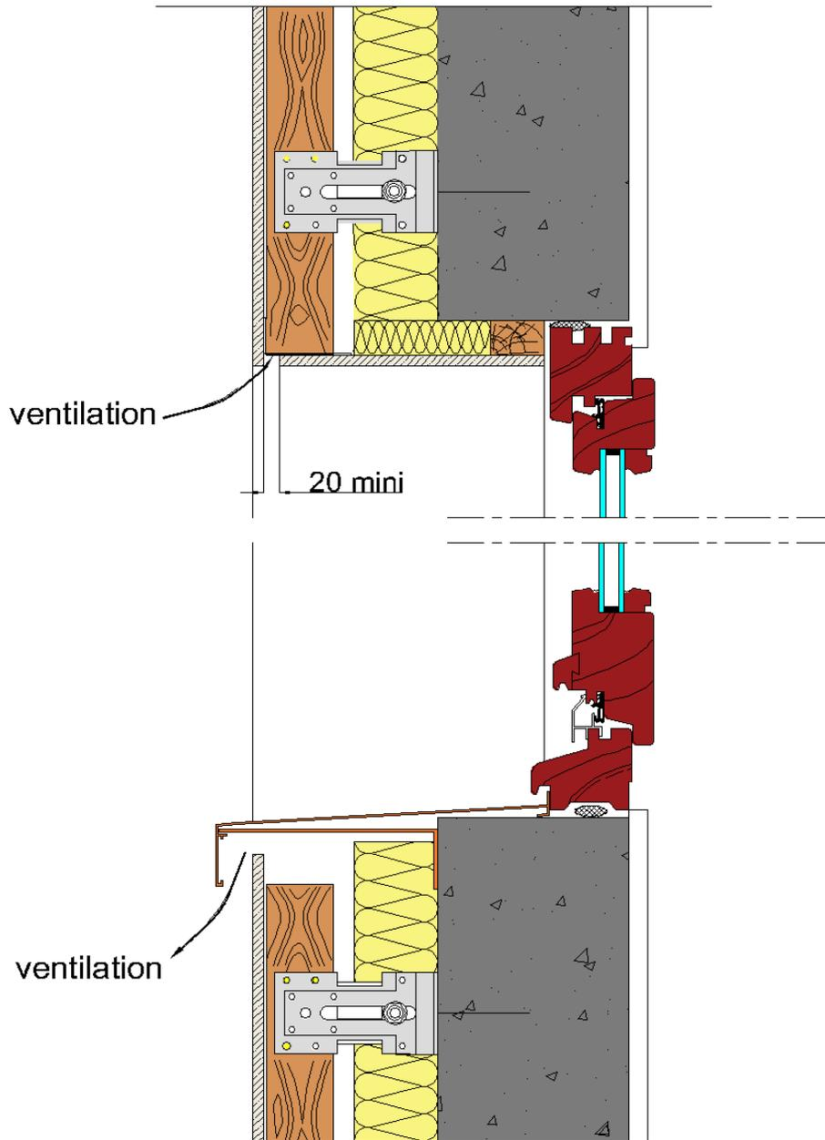
**Figure 13bis - Encadrement de fenêtre avec panneau *EQUITONE* en habillage de linteau**
